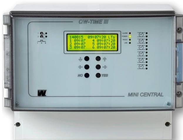
Die Mini-Zentrale ist eine Kombination aus Hauptuhr und Schaltcomputer. Die Mini-Zeitzentrale stellt sechs verschiedene Impulsausgänge zum Ansteuern der Nebenuhren und ein Jahresprogramm mit zwei Ausgängen zur Ansteuerung von elektrischen Funktionen (z.B. Beleuchtung, Pausensignal, Lüfter, Heizung, Türen, Tore) zur Verfügung. Zusätzlich verfügt sie über eine Ethernetschnittstelle, um im NTP-Betrieb arbeiten zu können-
